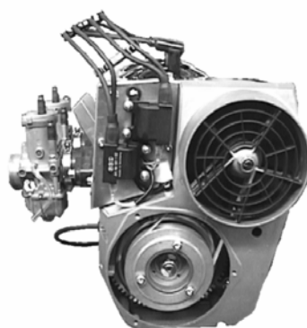
Bild 1.1.3-3 (Blick auf Zünderseite mit angebauter Zündanlage)
